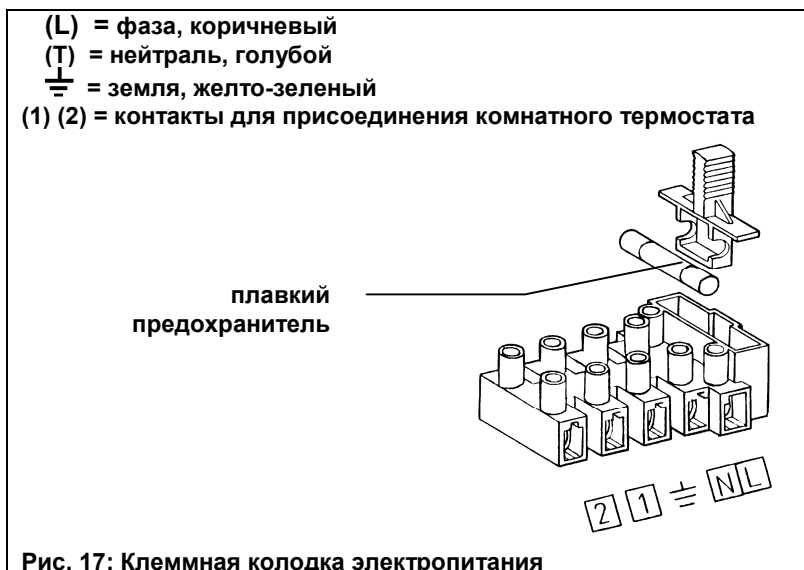
Рис. 17: Клеммная колодка электропитания
